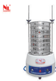
Triple Motion Sieves Shaker NL 1015 X / 010 Standard: EN 932-5, ISO 3310-1
